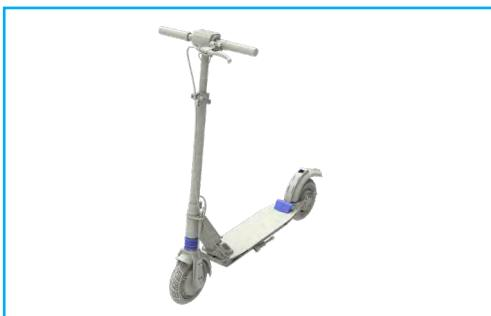
3. Haga encajar el gancho del tubo vertical en el pedal del freno trasero.
